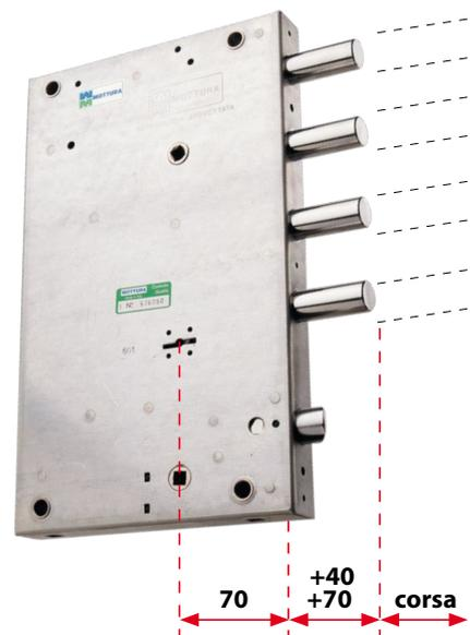
Alcune serrature della serie **64** possono essere fornite con CHIAVISTELLI ALLUNGATI di 40/70 mm. Contattare l'azienda per verificare gli articoli su cui è disponibile l'OPZIONE e il relativo AUMENTO di prezzo. **N.B.** si consiglia, per il buon funzionamento della serratura, l'uso di testiere di guida, la cui mancanza può causare guasti alla serratura.
