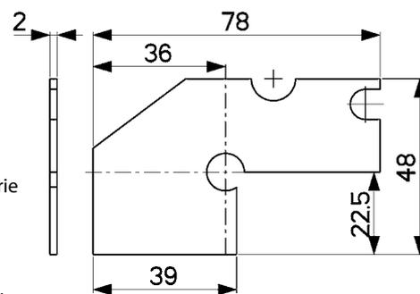
Tutti gli articoli delle serie **52** e **54** possono essere forniti con rinforzo interno, in materiale speciale, a protezione della serratura.
